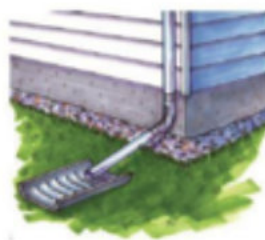
Écoulement dans un déflecteur
