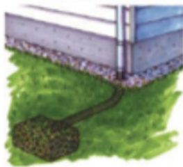
Écoulement dans un puit percillant à 1.5 mètres du bâtiment
